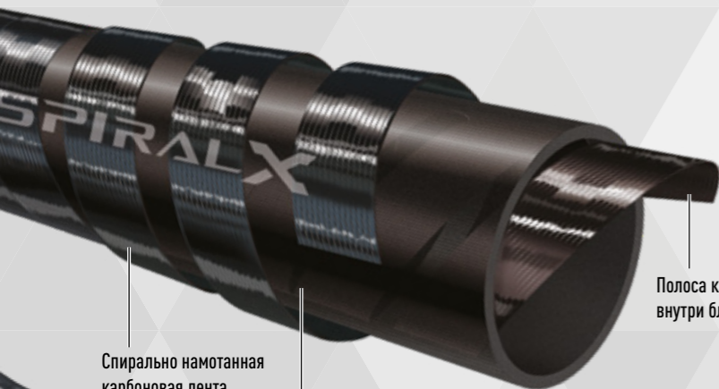
Спирально намотанная карбоновая лента Средний слой — углеткань с продольно расположенными волокнами Полоса карбоновой ленты внутри бланка
