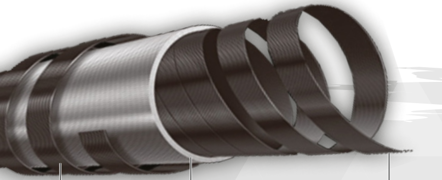
Спирально намотанная карбоновая лента Средний слой — углеткань с продольно расположенными волокнами Полоса карбоновой ленты внутри бланка
