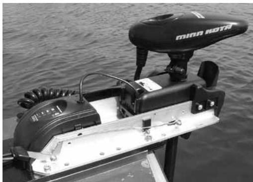
Установите крепление так, чтобы во время складывания и раскладывания вал не касался лодки. Крепежное кольцо подстраивается. При необходимости ослабьте отверткой винт и сместите кольцо вверх или вниз для изменения позиции мотора.
