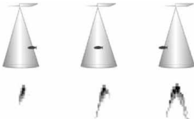
Лучи датчика излучателя и «арки» рыб
