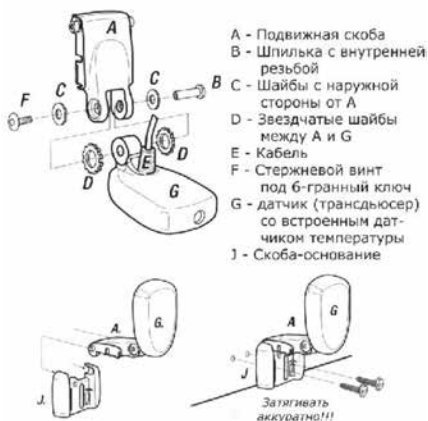
Рис. 4а. Сборка и крепление датчика Piranha 5x
