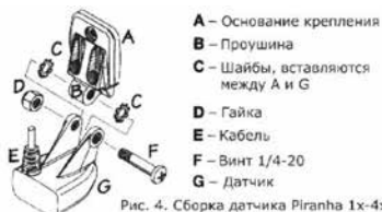
Рис. 4. Сборка датчика Piranha 1x-4x
